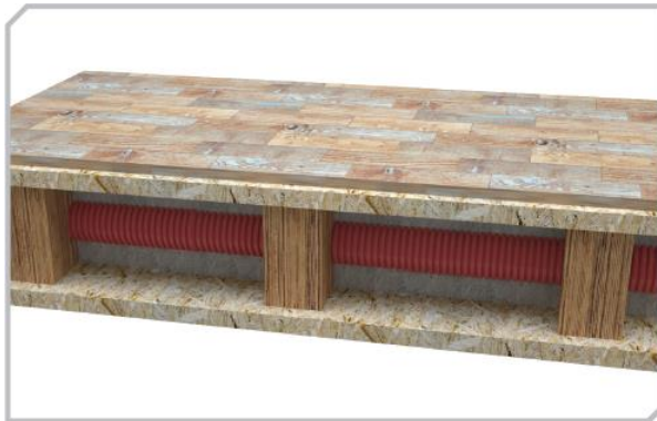
Innerhalb von Holzstrukturen durch die Balken
