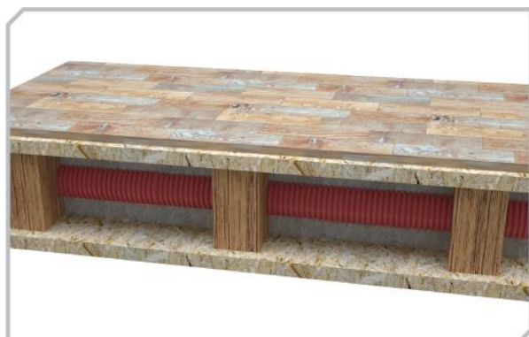
Innerhalb von Holzstrukturen durch die Balken
