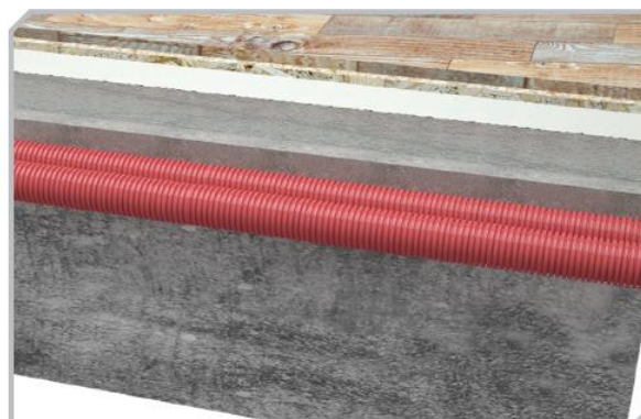
Eingebettet in den Zement (Estrich des Bodens)
