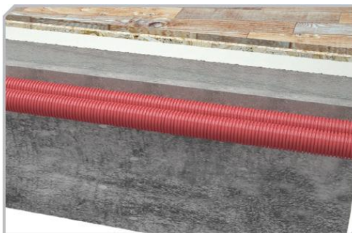
Eingebettet in den Zement (Estrich des Bodens)
