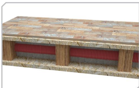
Innerhalb von Holzstrukturen durch die Balken
