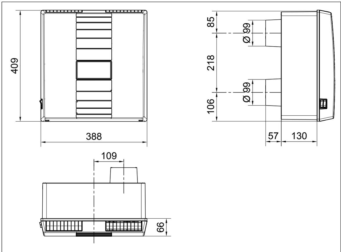
Abb. 4: Abmessungen Lüftungsgerät M-WRG-S in Millimeter
