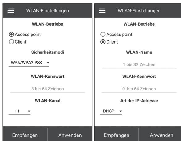
**Access point:** Zugangspunkt ohne Home-Router. In diesem Modus können bis zu 8 Mobilgeräte an den Ventilator angeschlossen werden. Wählen Sie die gewünschte Sicherheitsstufe für den **Access point**-Modus aus:
