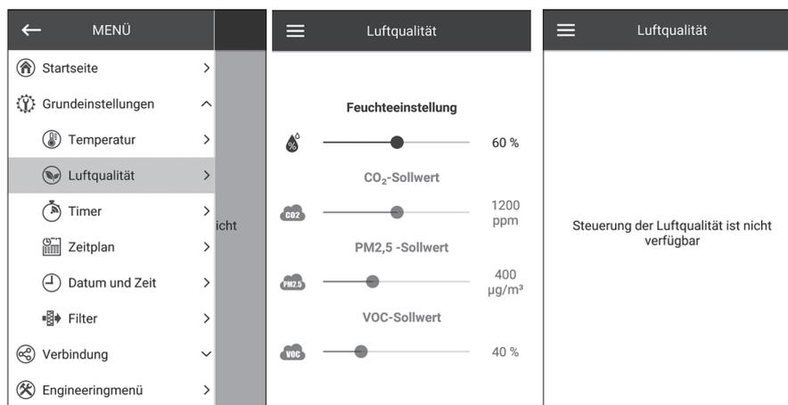
In diesem Menü werden die Feuchtigkeits-, CO<sub>2</sub>-, PM2.5- und VOC-Sollwerte eingestellt. Wenn einer dieser Werte überschritten wird, erhöht der PI-Regler der Steuereinheit die Ventilatorgeschwindigkeit gleichmäßig. Wenn sich die Sensorsignale wieder im Normalzustand befinden, reduziert die Lüftungsanlage die Ventilatorgeschwindigkeit schrittweise auf den Ausgangswert. Alle nicht aktiven Sensoren, die semitransparent angezeigt werden, sind nicht zugänglich.
