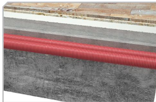
Eingebettet in den Zement (Estrich des Bodens)
