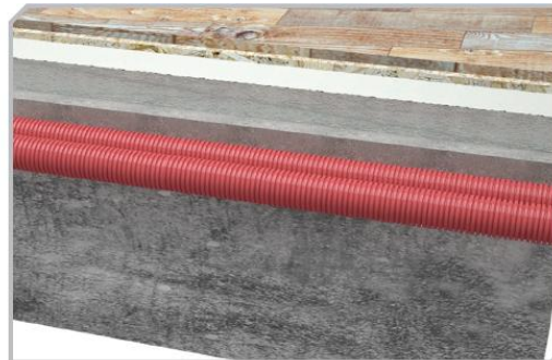
Eingebettet in den Zement (Estrich des Bodens)
