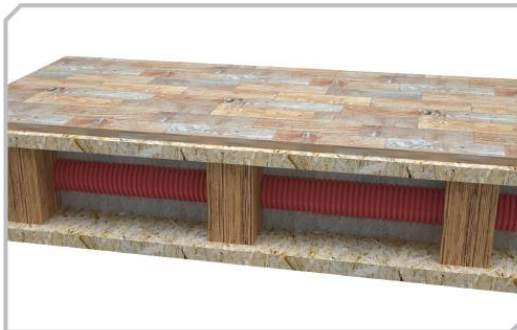
Innerhalb von Holzstrukturen durch die Balken
