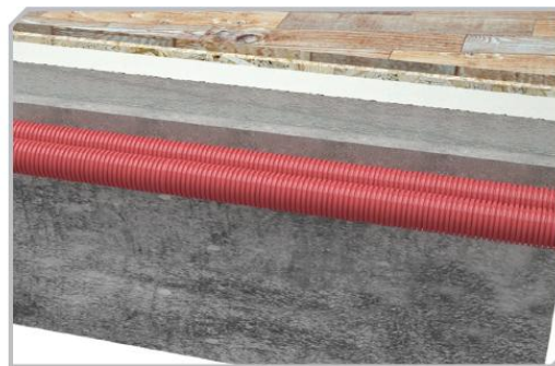
Eingebettet in den Zement (Estrich des Bodens)
