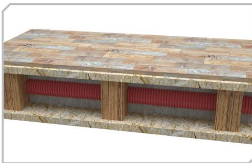
Innerhalb von Holzstrukturen durch die Balken
