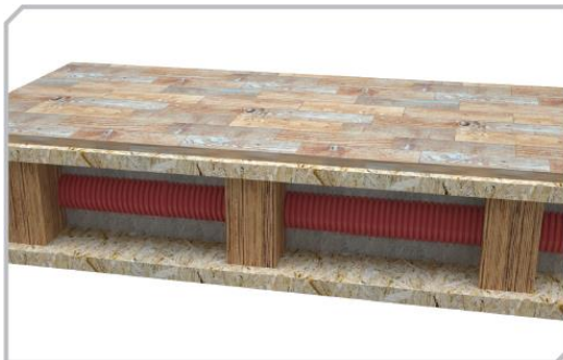
Innerhalb von Holzstrukturen durch die Balken
