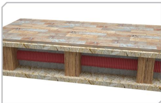
Innerhalb von Holzstrukturen durch die Balken
